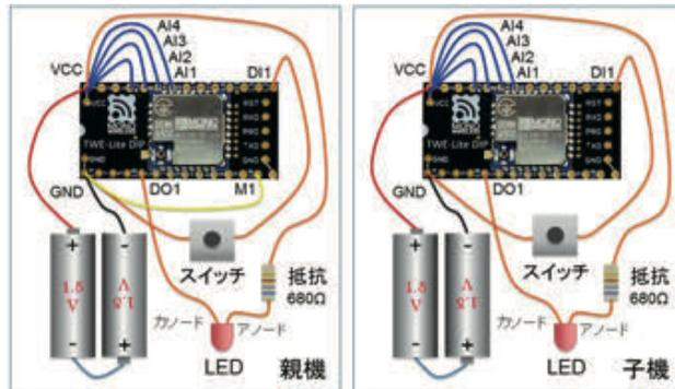
親機のスイッチをオンにすると子機の LED が点灯し、親機のスイッチをオフにすると子機の LED が消灯します。子機のスイッチをオンにすると親機の LED が点灯し、子機のスイッチをオフにすると親機の LED が消灯します。
